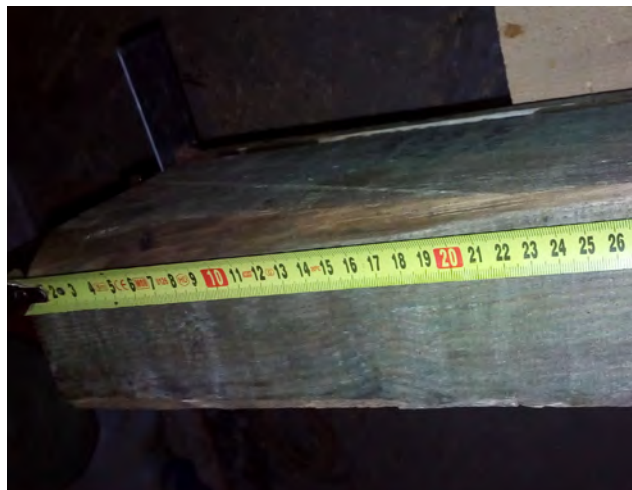
Fig. 9. Measurement of a single wane in pine sawn timber Rys. 9. Pomiar obliny pojedynczej tarcicy sosnowej
